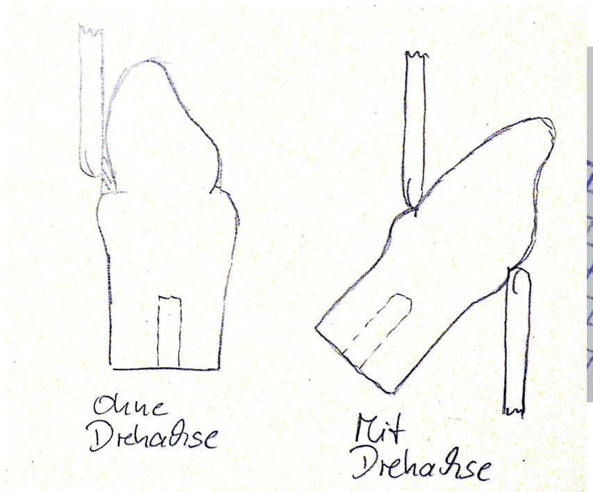
Simultanfräsen heißt, dass die Drehachsen während des Fräsvorgangs bewegt werden können (z.B. fünfachsigte Maschinen). Nicht simultane Maschinen können die Drehachsen nur bewegen, wenn die Fräse (bzw. die Spindel) im Parkposition steht und nicht bearbeitet.
